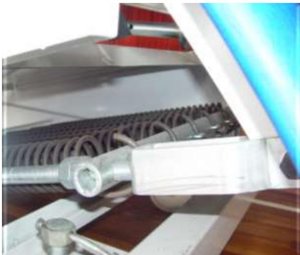
La canasta dispone de unos resortes tensados para su elevación manual con barra de seguridad telescópica anclada al poste delantero y trasero, con pasadores de seguridad los cuales disponen de tres topes, uno para juego de baloncesto, otro para juego de mini básquet y otro para su traslado y almacenaje.
